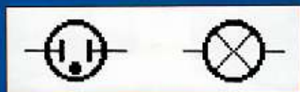
De schema-symbolen voor een gewoon lampje, rechts, en links het neonlampje. De punt binnen het glas geeft aan dat het lampje, of buisje, met gas is gevuld.
